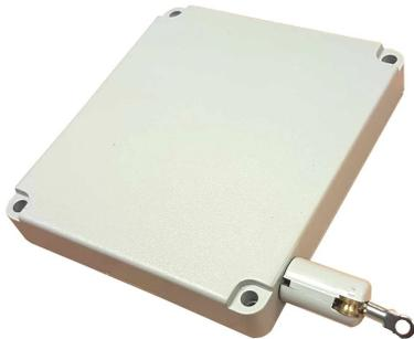
Contatto a fune per tapparelle e saracinesche. La costruzione particolare con collo allungato girevole e la guida a carrucola in ottone, facilitano l'installazione e garantiscono una lunga durata del filo di nylon. Il contatto è fornito a bordo di 2 morsetti NC, per l'uscita di allarme.
